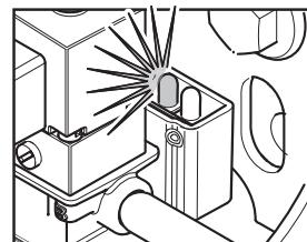
**DE** **Abb. 24.** Wenn die rote Lampe erlischt, wird ca. 10 Sekunden lang Luft zur Reinigung in den Mechanismus geblasen. Ein feiner Ölnebel wird eingespritzt und dann erfolgt ein weiterer, ca. 10 Sekunden langer Luftstoß in den Mechanismus. Die Funktionskontrolle ist jetzt abgeschlossen.
